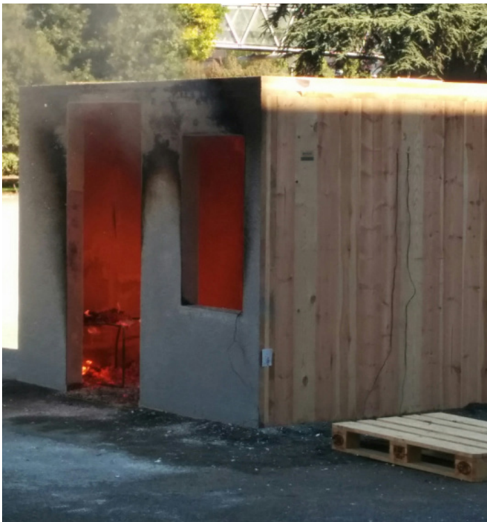
Test de incendio a escala real de una estructura CLT
